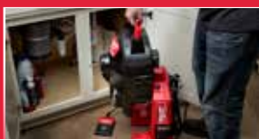
M18 FUEL™ SWITCH PACK™ – система подсоединения барабанов без инструментов, с помощью которой пользователи могут быстро менять тросы разных размеров и добавлять второй барабан для продвижения по линии на 30 м
