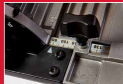
Параллельный упор с двумя направляющими крепится спереди и сзади пилы
