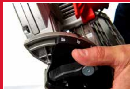
60° угол наклона диска
